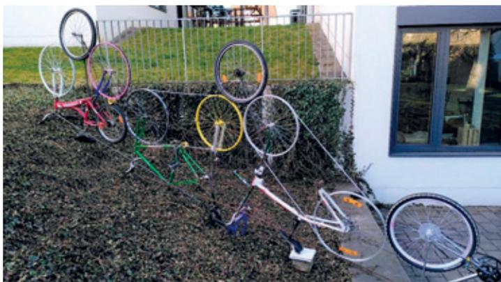
Dazu montierten die Schüler zu Beginn alle „unnötigen“ Fahrradteile, z. B. Gangschaltung, Bremsen, Beleuchtung, Gepäckträger vom Rahmen mit entsprechenden Werkzeugen ab. Räder wurden ummontiert, Rahmenteile mit der Trennscheibe entfernt und an anderer Stelle wieder zusammenge-
