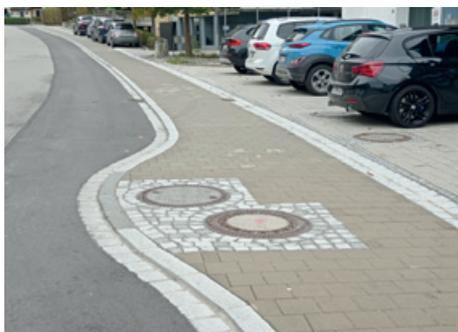
Bei mehreren Kanaldeckeln, die vor dem Bau noch in der Fahrbahn lagen, hat man aus der Not eine Tugend gemacht. Um die Schachtdeckel nicht aufwändig verlegen zu müssen, wurde der Bordstein um die Hindernisse verlegt. So entstanden kleine Fahrbahneingengungen, die verkehrsberuhigend wirken.
