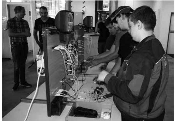
Die Übungswand hat den Zweck, den Auszubildenden für NFZ-Mechatronik der Firma Zosseder das Verbinden von Batterie, Zündschloß, Scheinwerfer, Blinker usw. im LKW zu ermöglichen. Auch das Messen von Strom und Spannung kann hier ohne Gefahr ausgiebig geübt werden. Das Aufspüren von simulierten Fehlern, wie z.B. defekte Sicherungen und Leuchtmittel und sogar Kabelbrüche, ist mit dieser Übungswand möglich.
