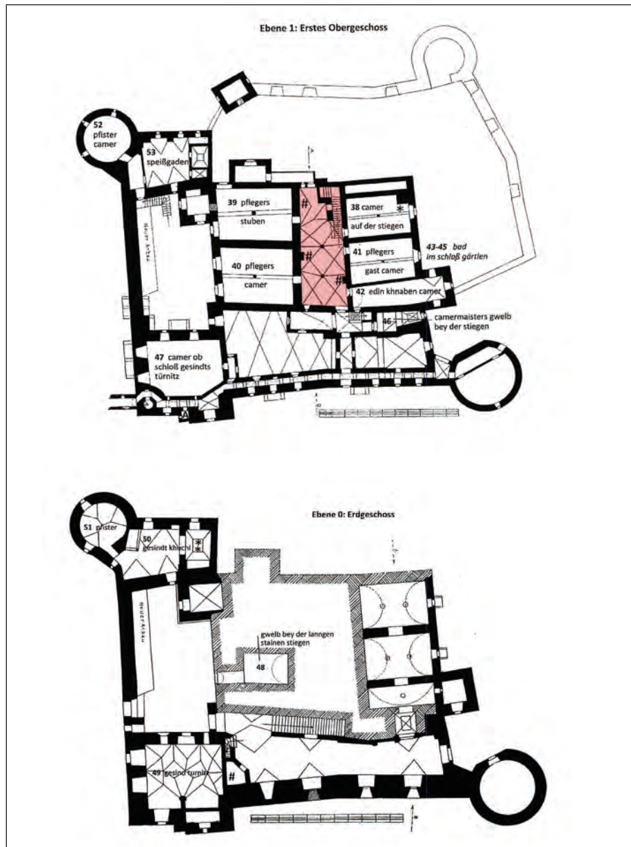
53 a Hohensalzburg, Inneres Schloss /Hoher Stock, Rekonstruktion der Raumaufteilung von 1540 (nach Riegel 2012), erstes Obergeschoss und Erdgeschoss. Markierung: Mittelflur mit Netzrippengewölbe.
