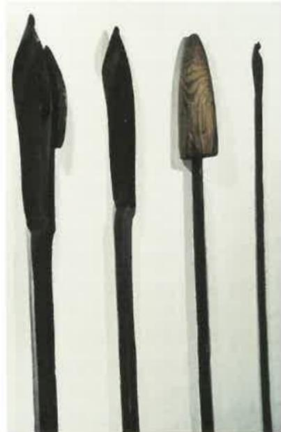
Abb. 9: Bohrwerkzeuge zur Herstellung hölzerner Wasserleitungsrohre, Städtisches Museum im Heimathaus Wasserburg a. Inn
