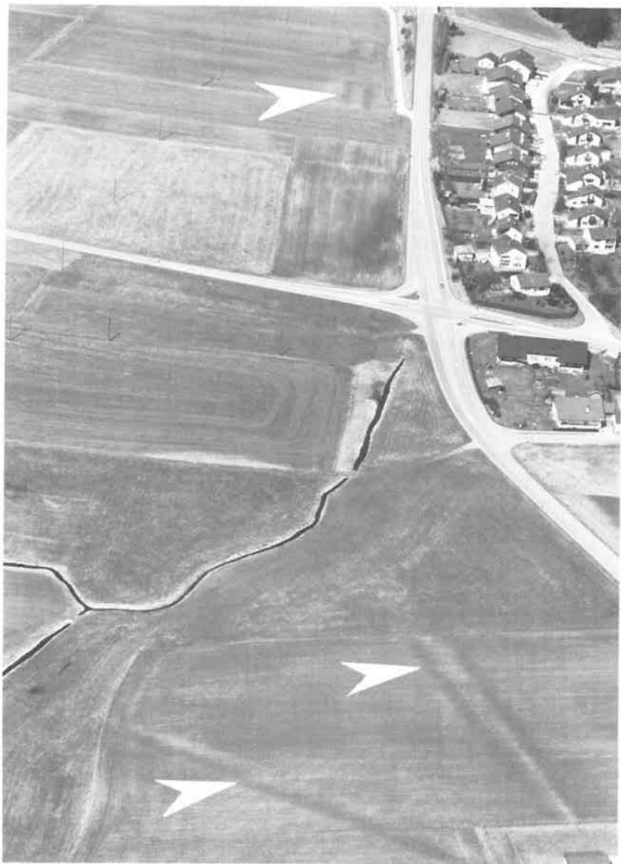
Abb. 9 Vermeintliche Altstraßenspuren bei Edling-West, die in Wirklichkeit vom Bau einer Wasserleitung herrühren.
