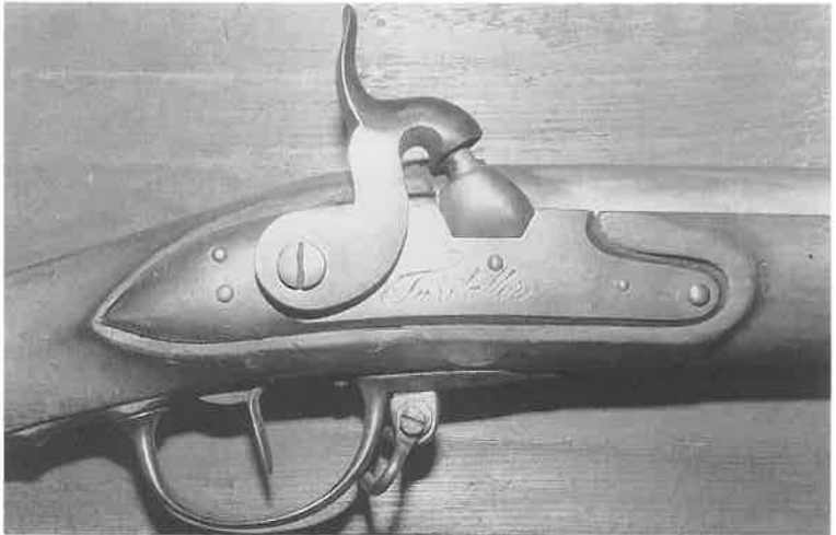
Abb. 4c: Österreichisches Infanteriegewehr M 1798, vom Steinschloßmechanismus auf Perkussionszündung umgebaut in der Werkstatt Fürstaller - Schloß mit gravierter Schloßplatte
