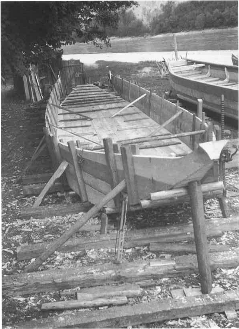
Abb. 15 Das Vorderteil ist fertig zusammenge-nagelt. Der Gransenkopf ist deutlich zu sehen.
